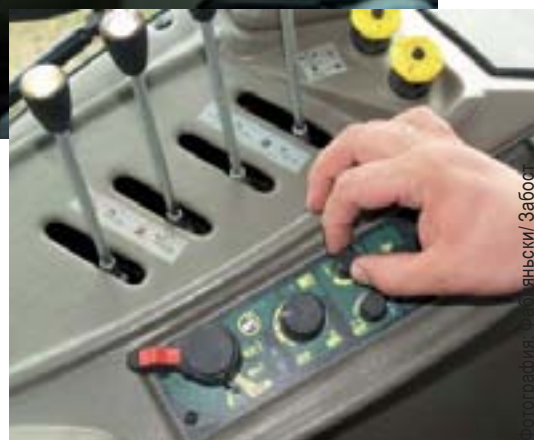
Фотография: На правом крыле находится большинство рычагов и электрогидравлических переключателей, управляющих системами трактора. Подъемное устройство обслуживается с удобной панели управления, оборудованной EHR
