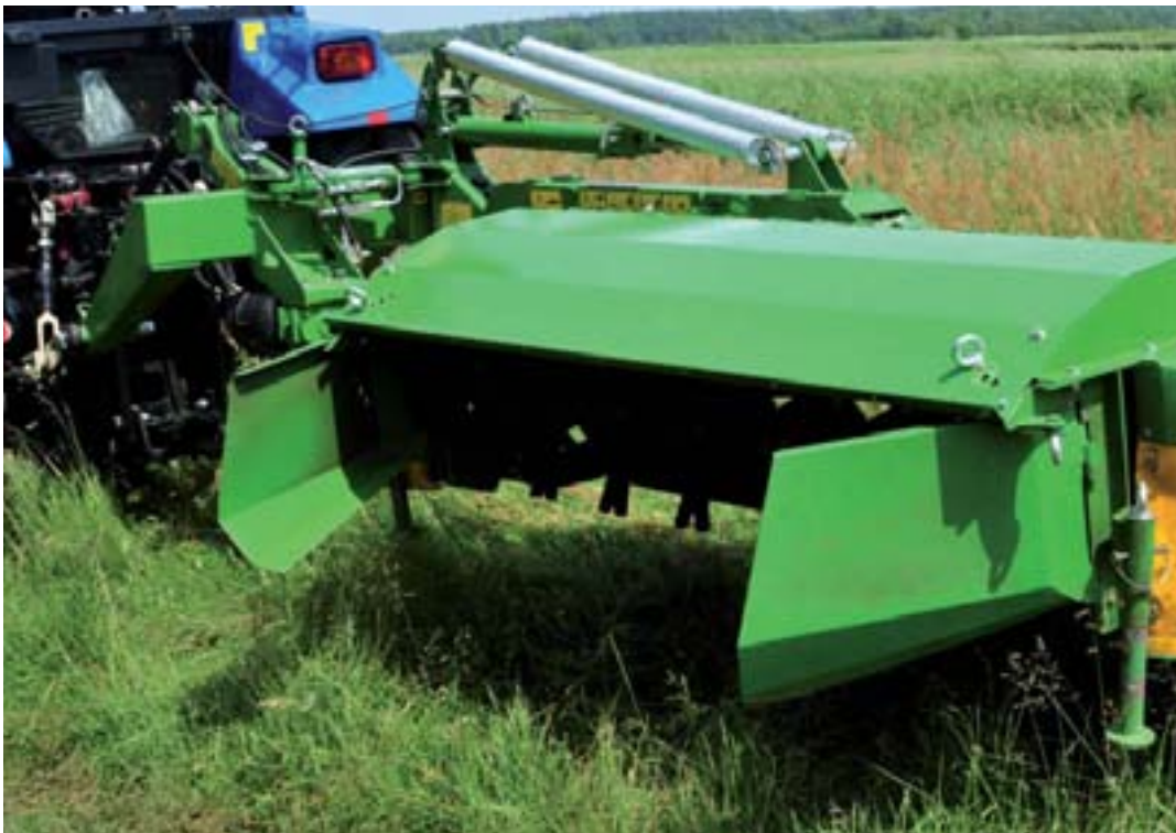
Фотография: Регулируемые металлические гребатели покоса
