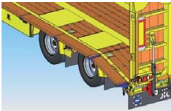
Фотография: Днище прицепа расширено до 3000 мм
