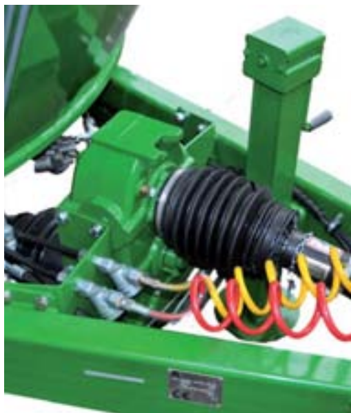
Фотография: Двухскоростная редукционная передача
