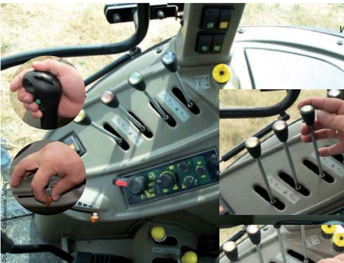
Фотография: На правом крыле находится большинство рычагов и электрогидравлических переключателей, управляющих системами трактора. Подъемное устройство обслуживается с удобной панели управления, оборудованной EHR
