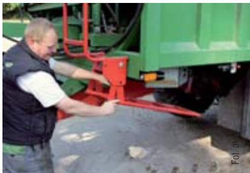
Фотография: Складываемая лесенка входит в серийное оснащение
