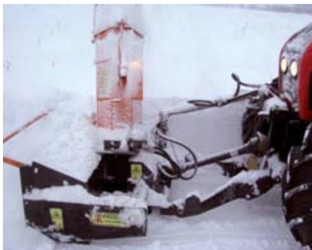
Фотография: Роторный снегоочиститель OW1.5 имеет TCH согласно ISO 730-1 категории I - II, требуемая мощность ВОМ - 25-60 л. с., необходимое число оборотов - не менее 540 в минуту
