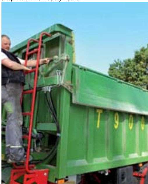
Фотография: Верхнюю часть стенки с левой стороны погрузочной платформы можно сложить с помощью размещенного спереди гидравлического цилиндра. Сзади регулировка осуществляется с помощью двигателя и ноги
