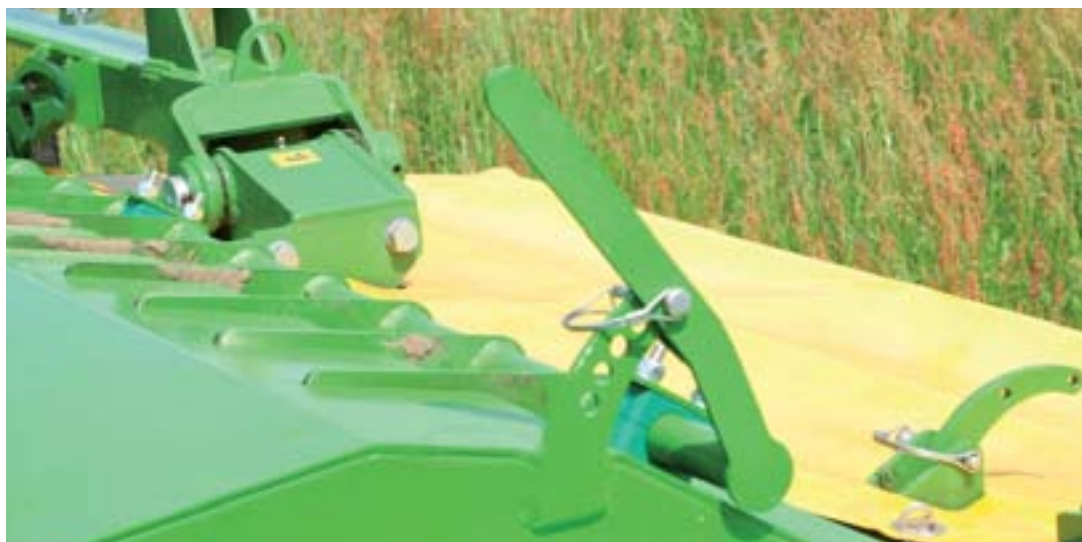
Фотография: Регулировка амортизации при проходе покоса
