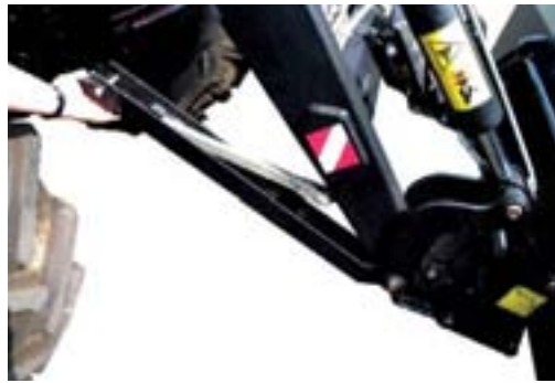
Фотография: Широкие подпоры, установленные на консоли погрузчика, позволяют быстро и безопасно перемещать его
