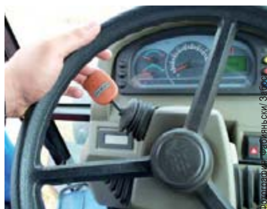
Руль регулируется на двух уровнях. Слева находится гидравлический реверс
