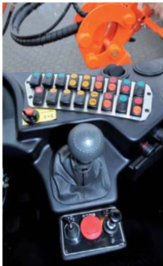
Фотография: Легкое, интуитивное управление плечами консоли с помощью джойстика
