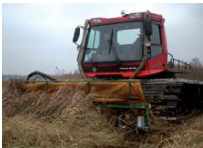
Фотография: Для скоса травы на водно-болотных угодьях необходимо специальное оборудование. На снимке - модернизированная фронтальная косилка фирмы Pronar PDF380R
